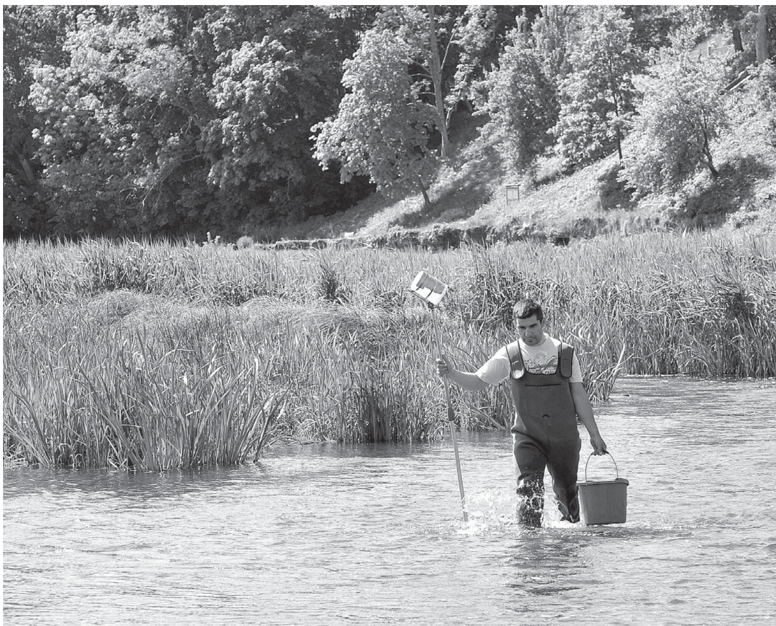
Hidrologs Mārcis Tīrums Ventā ņem virszemes ūdens paraugus, lai noteiktu tā kvalitāti un vides apstākļus upē pirms tīrīšanas.
