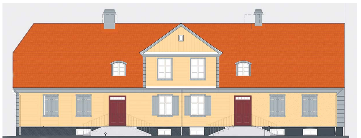
Veco rātsnamu plānots restaurēt, par pamatu ņemot tā vēsturisko plānojumu – atjaunot zudušās divviru durvis, logus, manteļskursteni, fasādi un citus elementus.
